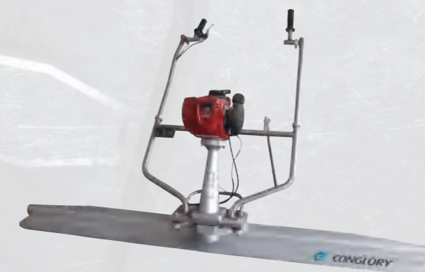
ПЛАВАЮЩАЯ ВИБРОРЕЙКА CSF-2 Двигатель: Honda Gx35 Мощность : 1.2KW Вес: 14kg Линейка: 1.8м/2.4м/3м/3.7м/4.3м/4.9м
