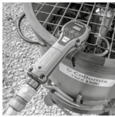
Montage op een mengtrommel
